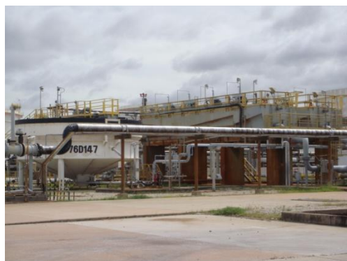
หน่วยแยกน้ำมันออกจากน้ำเสีย (Induced Air Floatation Unit)
